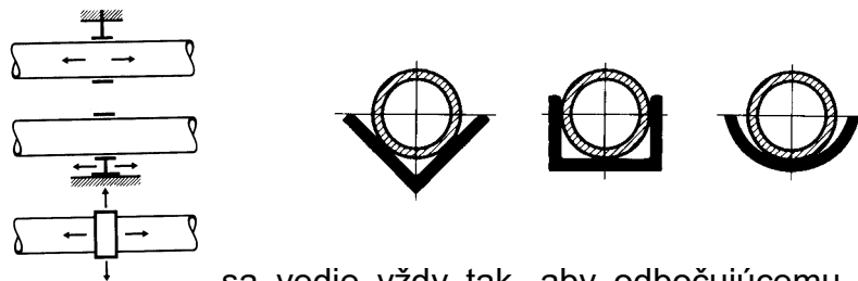
Obrázok 10 – Príklad klzného uloženia
